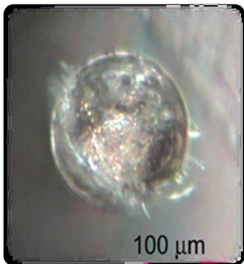
Micrografía del informe original. Escala indicada: 100 \mu\text{m} . Las inclusiones críticas pueden ser del orden de decenas a centenares de micras.
