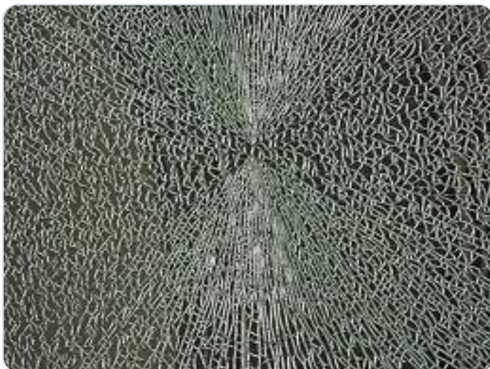
Patrón de fragmentación del informe original. La identificación causal debe localizar el origen real de fractura, no limitarse a observar el aspecto general del paño roto.
